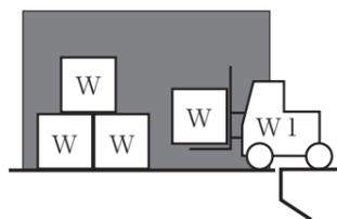
停止中最大荷扱量  $500\text{kg} \times 3 + (500\text{kg} + 1,000\text{kg}) = 3,000\text{kg}$
