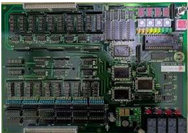
制御盤内の制御基板 型式:DM-101-8
